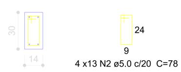
Armação negativa das lajes do pavimento cintamento (Eixo X)
