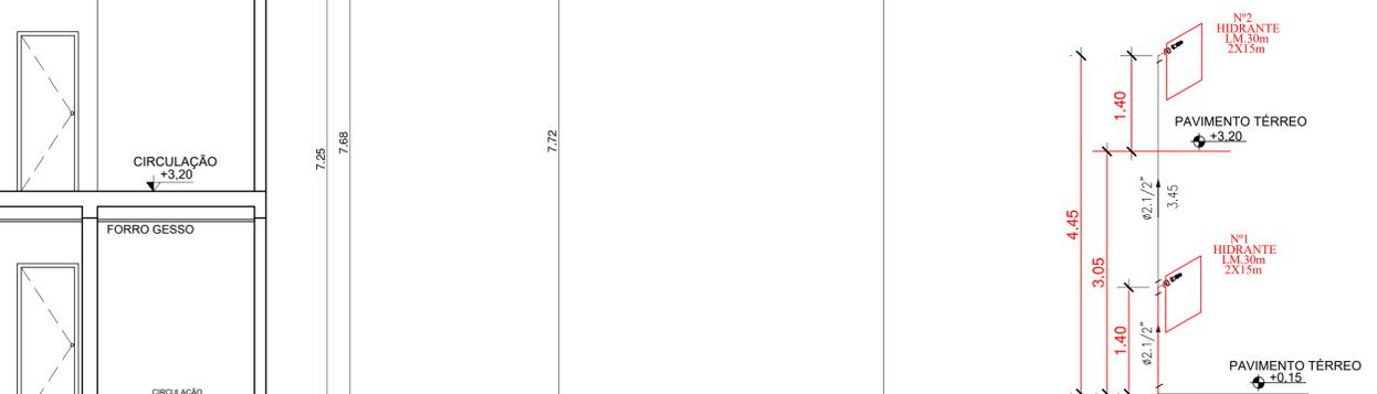
TUBO DE Fº Gº Ø 2.1/2" embutido no piso comprimento:25,30m
