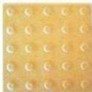
O assentamento será efetuado sobre base em lastro de concreto no traço 1:2:3 com 18 MPa e espessura de 8,0 cm, com argamassa pré-fabricada da Quartzolit específica para área externas ou argamassa de cimento e areia média no traço 1:3. As juntas receberão aplicação de rejunte flexível.
