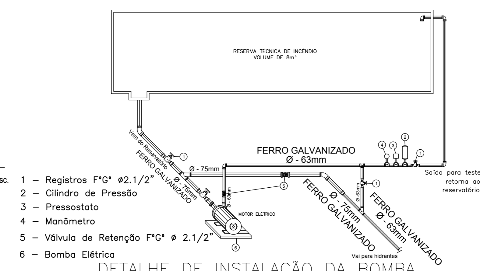
DETALHE DE INSTALAÇÃO DA BOMBA
